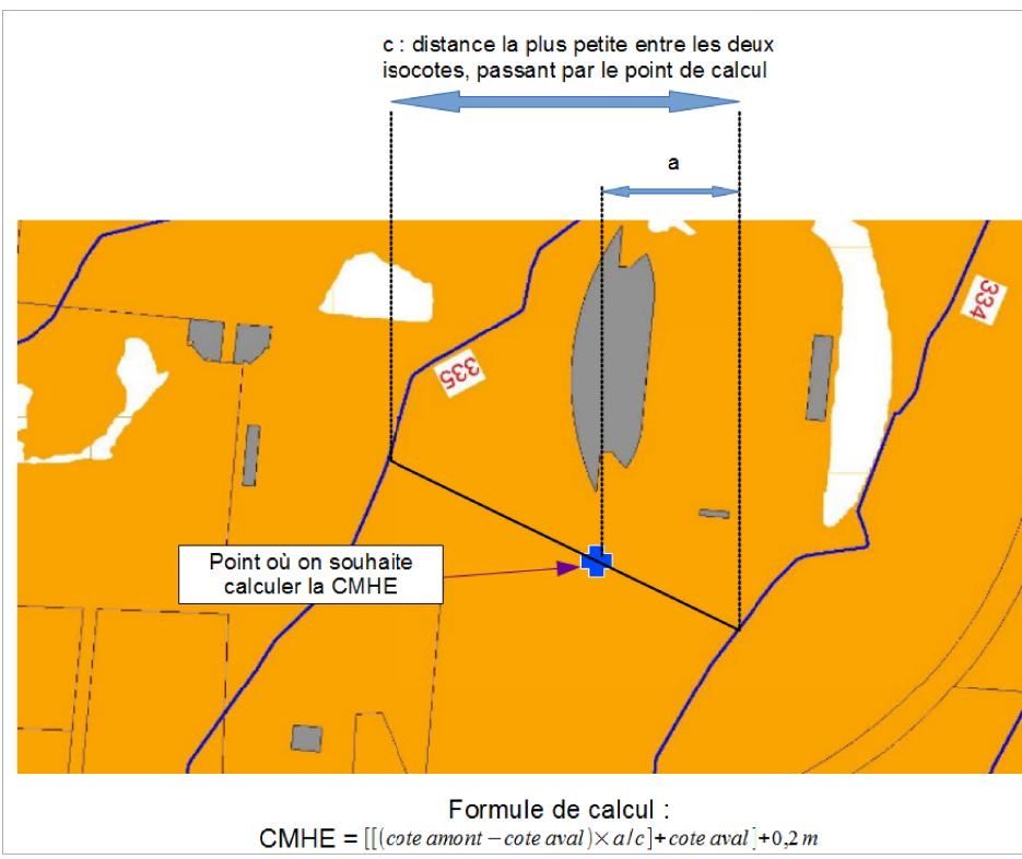
Exemple de calcul : a= 100m ; c=300m ; cote amont : 335 ; cote aval : 334
