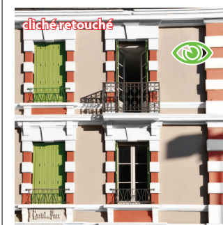
Deux exemples de contraste "trop" faible entre le fond et la modénature (en haut fond sombre, en bas fond clair). On ne "lit" plus l'architecture du bâtiment.
