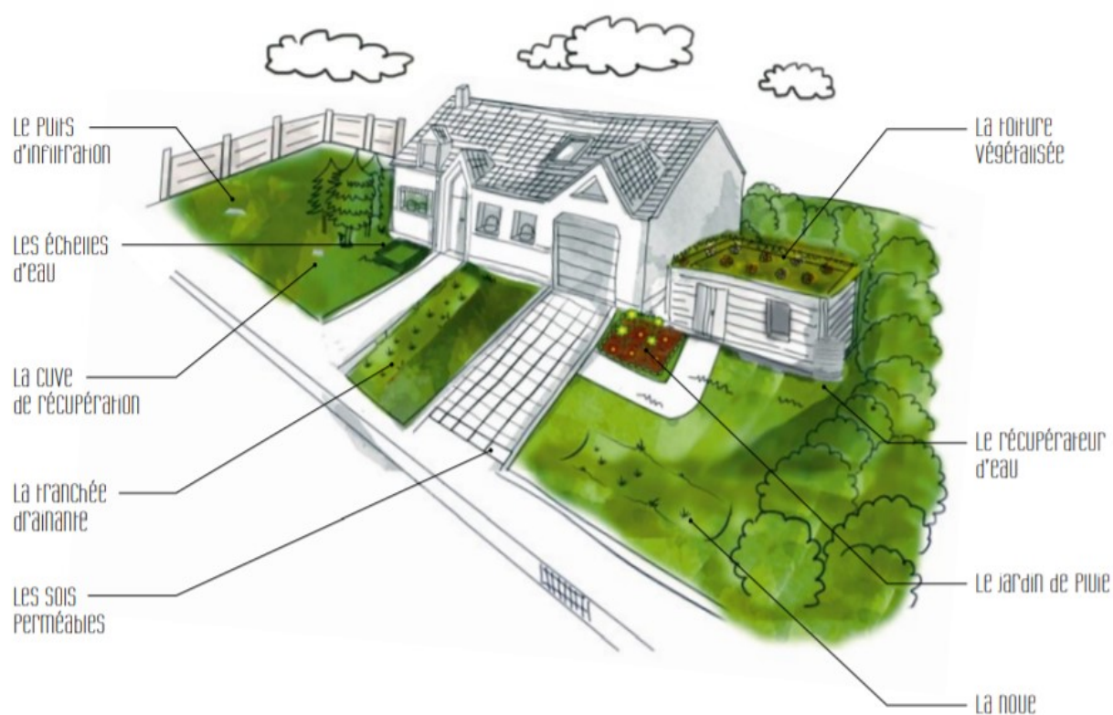
Figure 5 : Techniques alternatives à l'échelle d'une parcelle- Source ADOPTA
